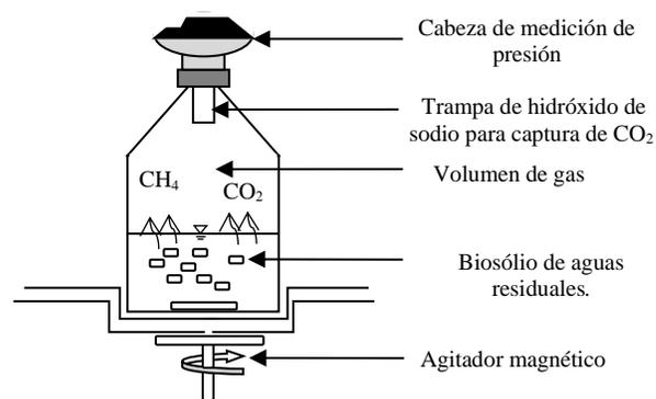
**Figura 3.** Componente y funcionamiento del Sistema Oxitop
