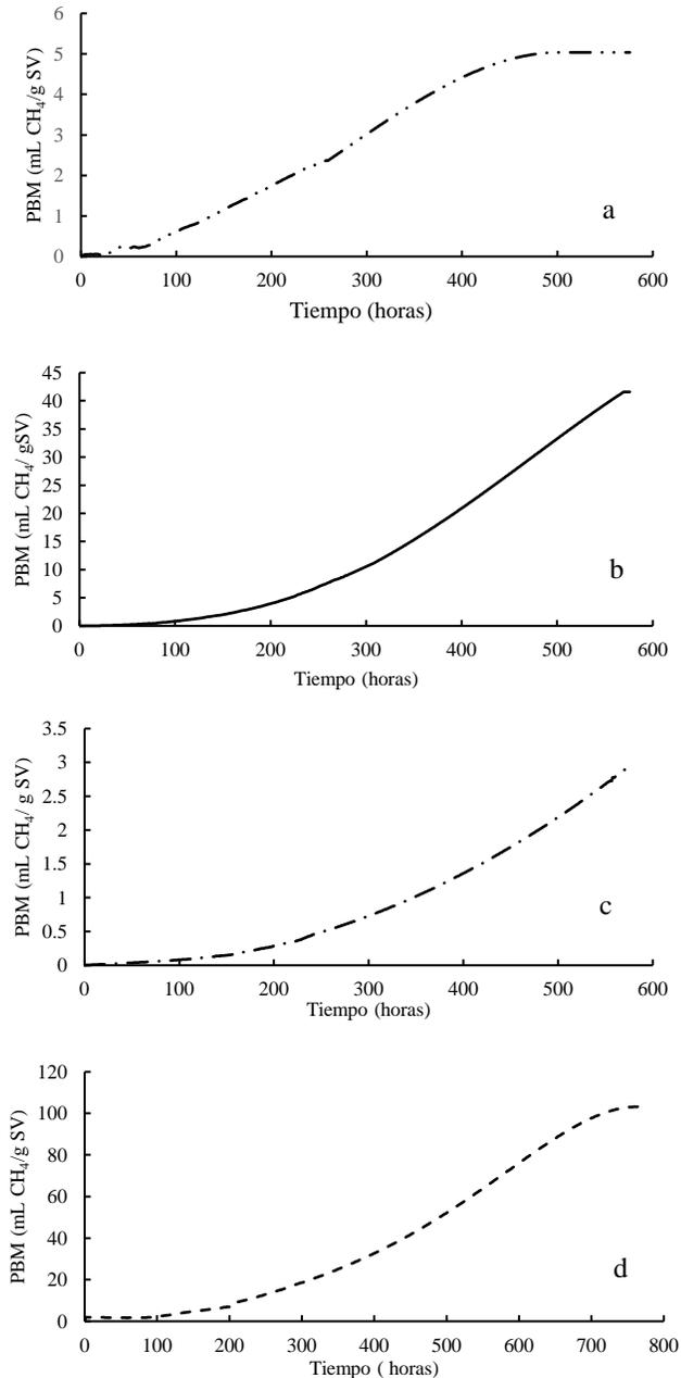
**Figura 4.** Potencial Bioquímico de Metano estimado para cada actividad económica, en base a los valores de presión registrados de los ensayos de digestividad anaeróbica: a) Avícola; b) Comercial; c) Hotelera; d) Municipal.
