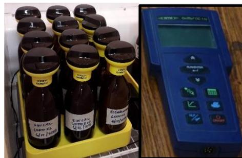
**Figura 2.** a). Sistema de medición Oxitop. b) Interface OC110.
